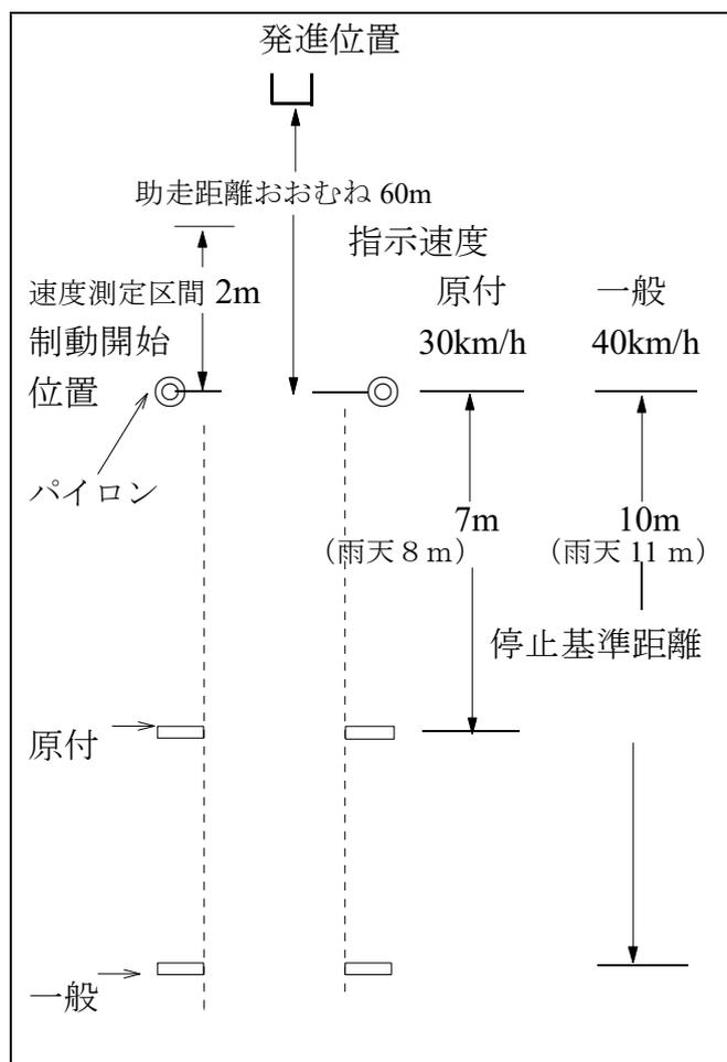
※ 停止基準距離オーバーは、前輪の先端で計測する。
